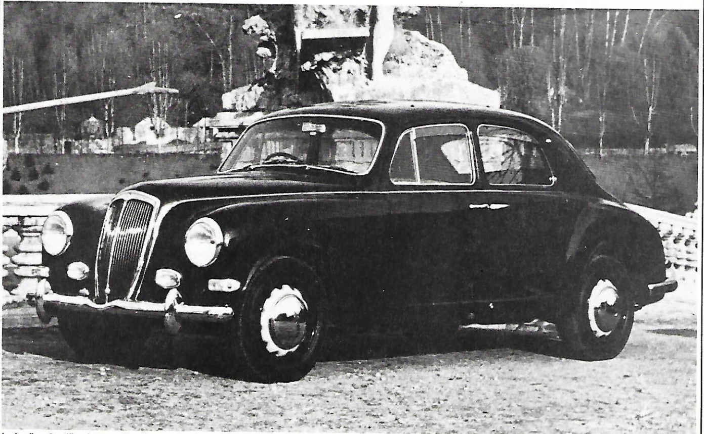
La berline Aurélia, dans sa dernière version, la B12. Notez les nouveaux pare-chocs non nervurés, les déflecteurs aux vitres avant, les anti-brouillards et les clignotants qui ont remplacés les flèches.
