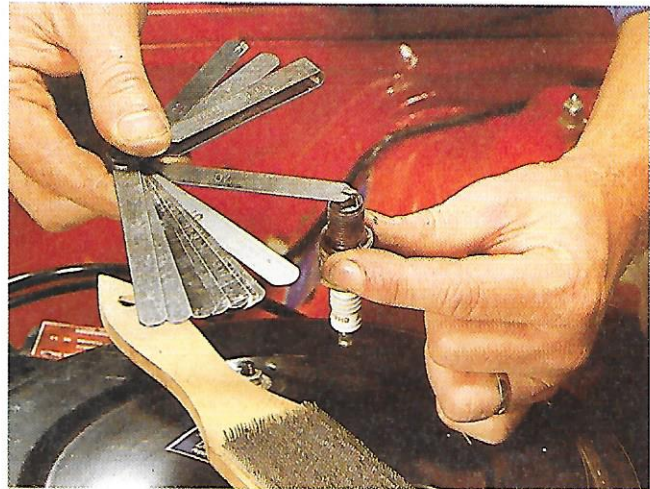
5 Tous les 10 000 km, déposez les bougies; contrôlez leur état et l'écartement des électrodes. Si elles sont usées, remplacez-les.
