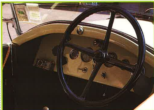
De l'inédit partout: le cadre inférieur du pare-brise fait partie du châssis alors que le tableau de bord y est vissé.
