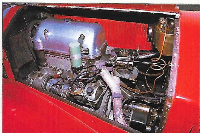
Le V4 à arbre à cames en tête est passé de 2 120 cm 3 au début de sa carrière à 2 570 cm 3 à la fin, et de 49 à 69 chevaux. Le régime maxi de ce moteur, fixé à 3 250 t/mn, était très élevé pour l'époque. La boîte de vitesses ne faisait pas corps avec le bloc, mais était boulonnée sur une traverse derrière le volant d'inertie.
